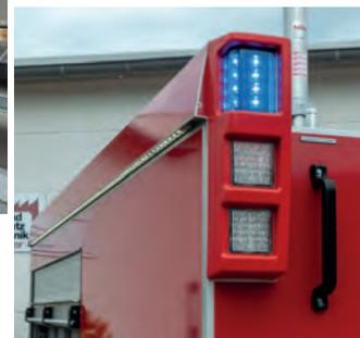
• LED Heckblaulicht, LED Blinker, Stand- und Bremslicht, LED Umfelbeleuchtung.
