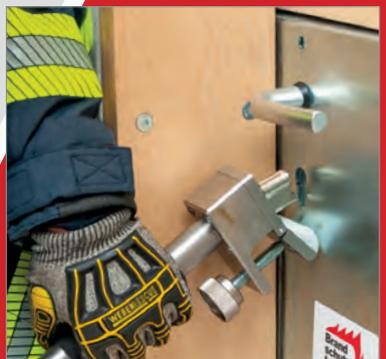
• Einhängen der Zugschraube in die Aussparung im **multiZETTEX**.
